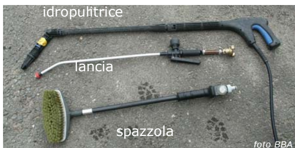
Fig. 89 – Differenti attrezzature per il lavaggio esterno dell'irroratrice.
