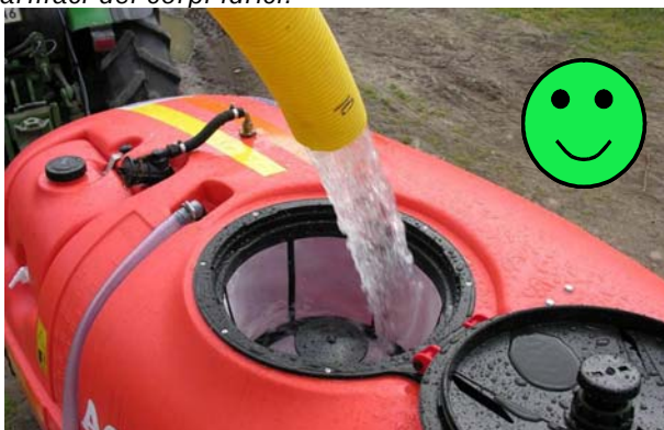
Fig. 61 – Corretto riempimento del serbatoio dell'irroratrice (foto ISK) .
