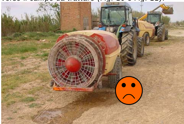
Fig. 10 – Assicurarsi che non ci siano perdite di prodotto dall'irroratrice durante il trasferimento in campo (foto CMA).
