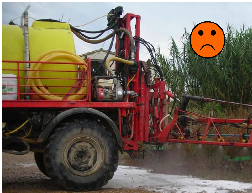
Fig. 74 – Attivare l'erogazione della miscela fitoiatrice quando l'irroratrice è ferma comporta un elevato rischio di inquinamento del suolo e delle acque (foto UPC).
