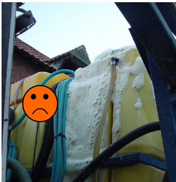
Fig. 55 – Traboccamento della miscela fitoiatrica del serbatoio principale della macchina irroratrice (foto E. Nilsson – Visavi).
