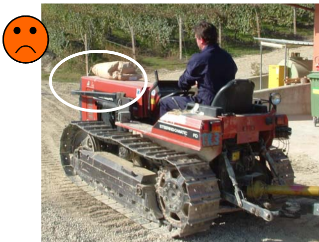
Fig. 9 – Trasporto di un sacco di prodotto in polvere in maniera NON sicura.
